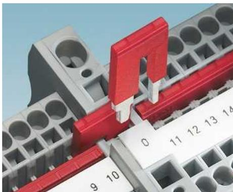
Переходная перемычка обеспечивает возможность простого соединения клемм разного номинального сечения. Она позволяет быстро компоновать блоки питания, например, соединять пружинную клемму ST 10 с клеммой ST 2,5 или ST 4.
