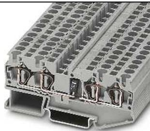
1,5 А, диодная клемма, 1N 5408 (1000 В/1,5 А), 4 разъема
