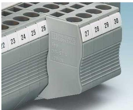
Сегменты крышки перекрывают выступающие клеммные сегменты трех- и четырехпроводных клемм, при подсоединении двухпроводных клемм. При этом обеспечивается защита от прикосновений.
