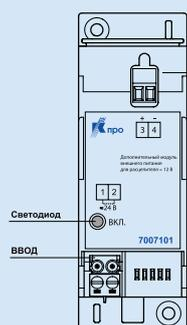
Устройство представляет собой преобразователь напряжения со входом  $\sim / = 24В$  и предназначено для использования с автоматическими выключателями серии ВА50-45 Про. Сила тока на выходе преобразователя составляет до 250 мА. Зеленый светодиод указывает, что преобразователь включен и присутствует выходное напряжение.
